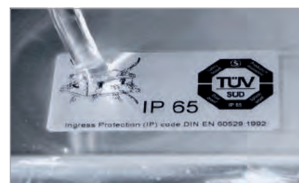
Strahlwasserschutz nach Norm IP 65
