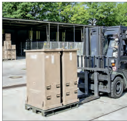
Palettenunterbau vereinfacht das Handling
