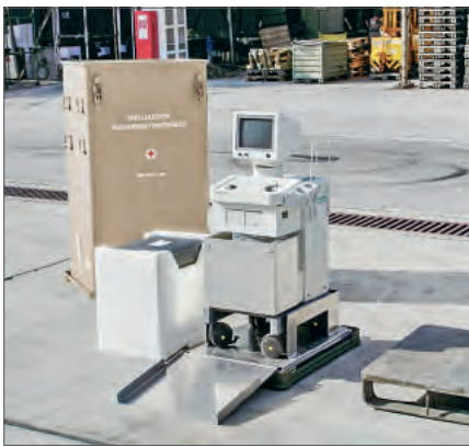
Unterteil mit Auffahrrampe
