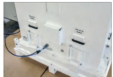
Wasserdampfdichter Behälter bei Dichtheitsprüfung durch Überdruck
