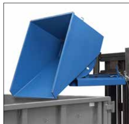
Selbstkipper als Schrottbehälter mit Gabelstapler
